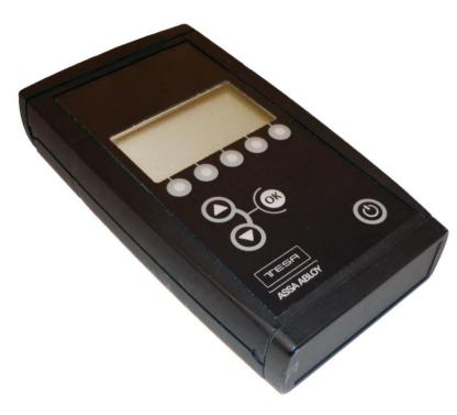
El programador Portátil es el dispositivo que permite comunicar los dispositivos offline (cerraduras, lectores murales) con tecnología de banda magnética con el PC y el software TESA Hotel.
