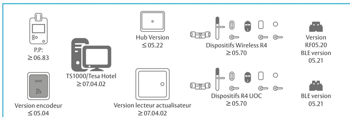
**Etape 2 Télécharger la base de données et firmware au P.P. et mettre à jour le plan de verrouillage des dispositifs**
