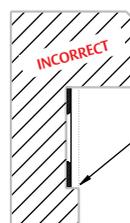
Incorrect : la serrure doit être installée au ras du cadre ou en superposition.
