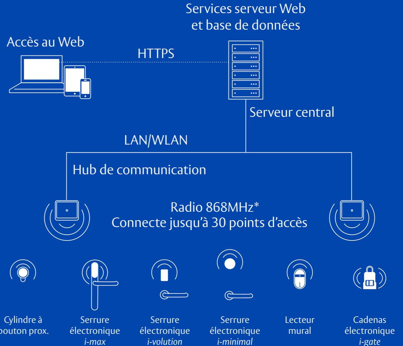
Les dispositifs électroniques et sans fil communiquent via une technologie de radiofréquence activée par des hubs de communication TCP/IP entre le serveur central et chacune des portes à contrôler.
